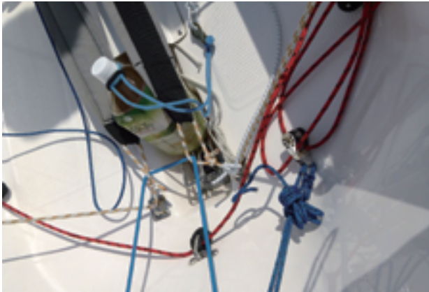
ホルダーを艇内に縛り付けておくことで、沈んだ際にボトルの海への流出を防止
